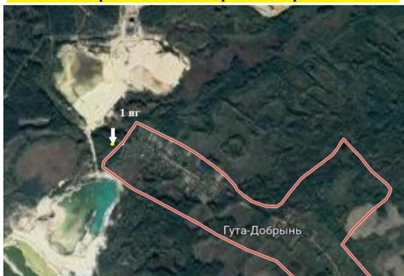
Рисунок 4.10 – Схема розміщення спостережних свердловин по прогнозній межі депресійної воронки (лінія свердловин), що формується при осушенні кар'єрами Юрської ділянки родовища
